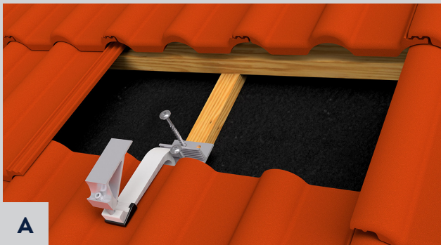
A Dachhaken montieren
